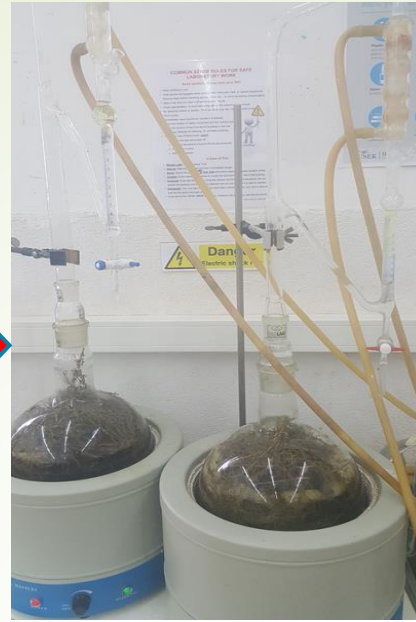
Distillation par la méthode de Clevenger
